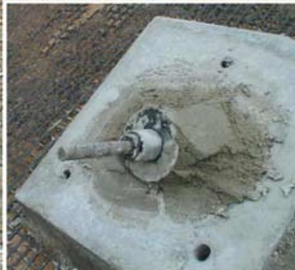
**CARBOPREE®** è una nuova linea di prodotti composta da barre realizzate con fibre di carbonio impregnate con resina vinilestere e superficie ricoperta con sabbia di quarzo.
